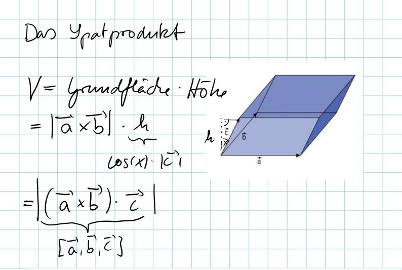
Der von den drei Vektoren  $\vec{a}$ ,  $\vec{b}$ ,  $\vec{c}$  aufgespannte SPAT (auch PAR-ALLELFLÄCHE oder PARALLELEPIPED genannt) hat das Volumen
