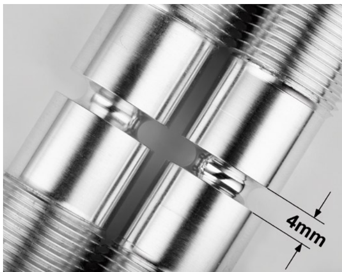
Abb. 6: Standardisierter gekerbter Probekörper.
