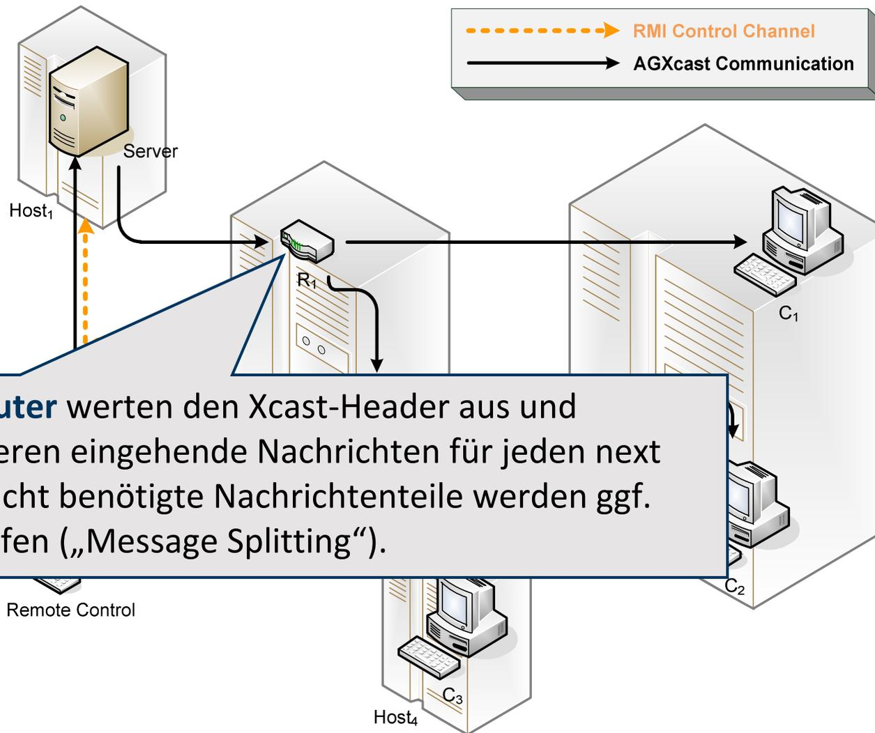
Die **Router** werten den Xcast-Header aus und duplizieren eingehende Nachrichten für jeden next hop. Nicht benötigte Nachrichtenteile werden ggf. verworfen („Message Splitting“).
